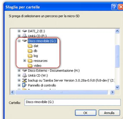
Se si copiano le configurazioni sulla micro SD, queste devono poi essere lette da **SmartyCam** una volta che la micro SD è inserita nella **SmartyCam** stessa. A tal scopo si utilizzi la tastiera della camera; il percorso è: **Menu >> Configura >> Carica Conf.** Si veda il manuale utente della camera per ulteriori informazioni relative a questa funzione.
