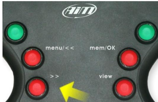
Premendo il tasto “>>”, evidenziato sopra è possibile visualizzare a destra del display i campi 1 e 2 oppure 3 e 4 impostati nella configurazione via software del visore.
