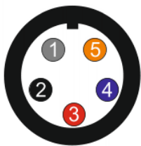
Pinout connettore Binder 712 - 5 pin femmina vista lato terminazioni di saldatura
