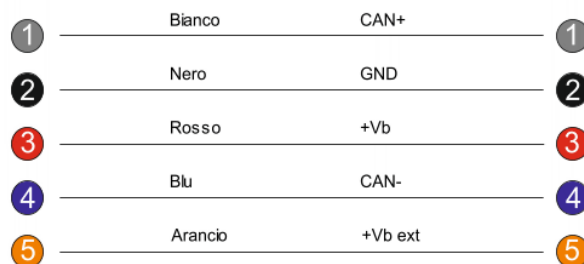
Pinout connettore Binder 712 - 5 pin femmina vista lato terminazioni di saldatura
