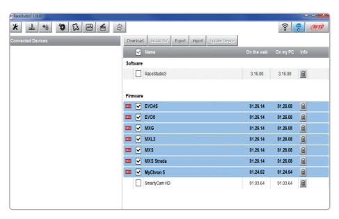
Quando il nuovo firmware è stato scaricato, collegate il vostro strumento al PC via Wi-Fi per aggiornare il firmware. In pochi secondi lo strumento sarà pronto.
