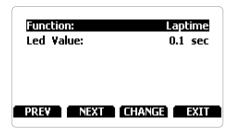
Qui è possibile impostare i 10 LED laterali di Solo 2, la loro funzione e la modalità di funzionamento (Led value).
