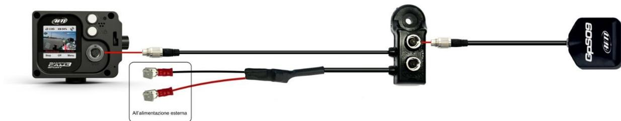
Per collegare **SmartyCam 3 Dual** al modulo GPS si utilizzi il cavo etichettato "EXP" del cablaggio per il connettore Deutsch a 22 pin femmina.
