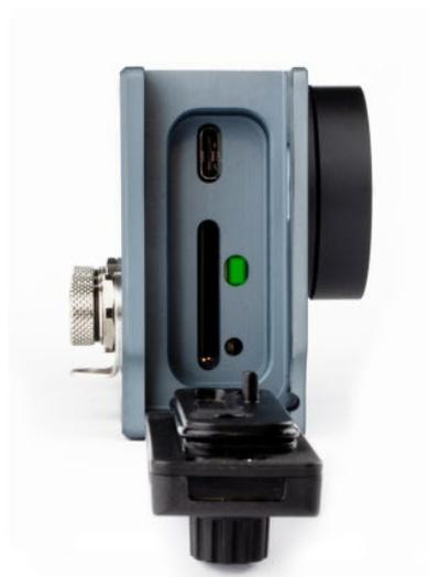
**SmartyCam 3 GP, SmartyCam GP Pro e SmartyCam 3 Corsa** montano un LED nell'alloggiamento della SD che cambia aspetto a seconda del messaggio che vuole dare.
