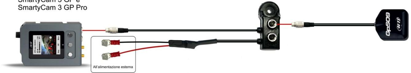
Per collegare **SmartyCam 3 Corsa** al Modulo GPS utilizzare il connettore Binder 712 a 5 pin femmina etichettato "GPS".
