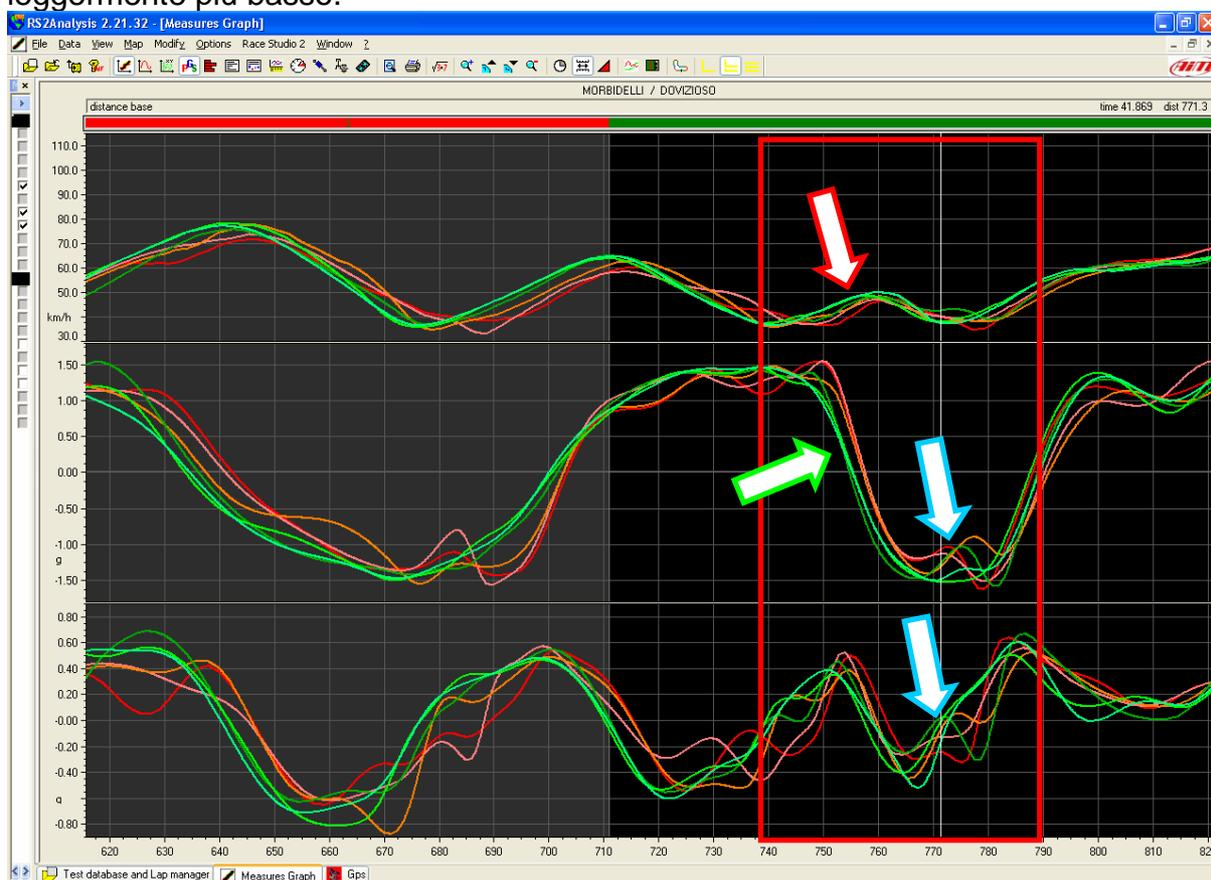
Il grafico mostra, dall'alto al basso, la velocità, lo slittamento delle ruote posteriori e la somma delle accelerazioni.
