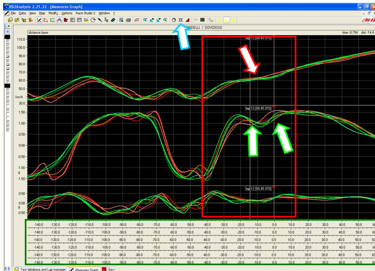
Il grafico mostra, dall'alto al basso, velocità, slittamento e somma delle accelerazioni. Lo slittamento è maggiore in inserimento per Morbidelli, poi ha valori identici. L'accelerazione totale è più bassa per Morbidelli in ingresso perché ha minore accelerazione laterale; questo succede perché a parità di traiettoria ha un po' di velocità in meno.
