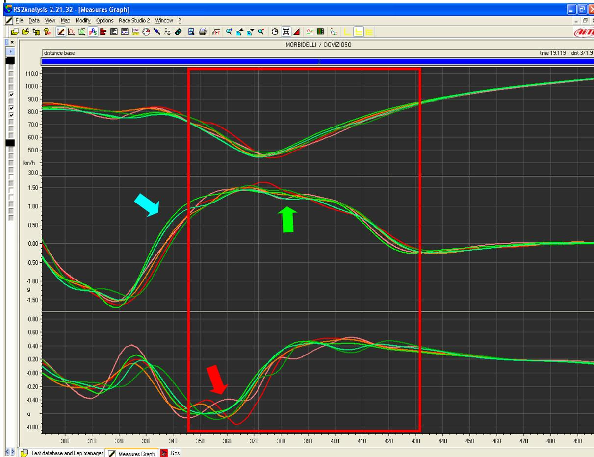
Il grafico mostra, dall'alto al basso, velocità, slittamento e somma delle accelerazioni. In questa figura si nota molto bene come lo slittamento sia leggermente minore di 1 a causa del bloccaggio posteriore durante la fase di frenata per diventare maggiore di 1 in accelerazione a causa di un leggero sovrasterzo (si stabilizzerà al valore di 1 nel successivo rettilineo). Le differenze tra i due piloti non sono significative.
