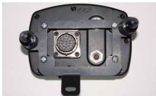
Figura 18: MyChron 3, staffa e perni di fissaggio—vista posteriore.
