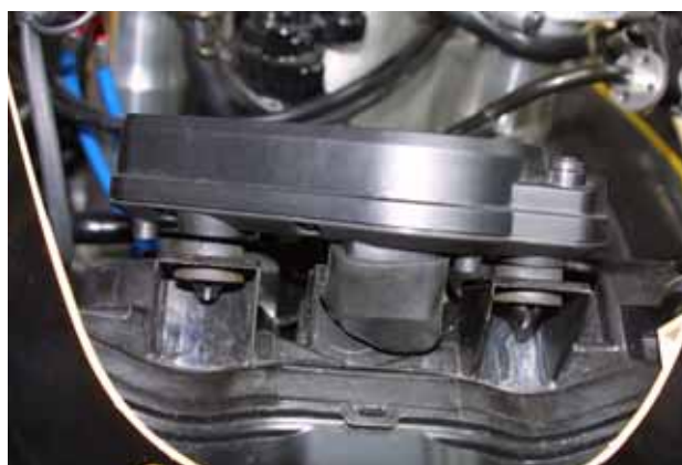
Figura 10: Rimozione del cruscotto di serie.
