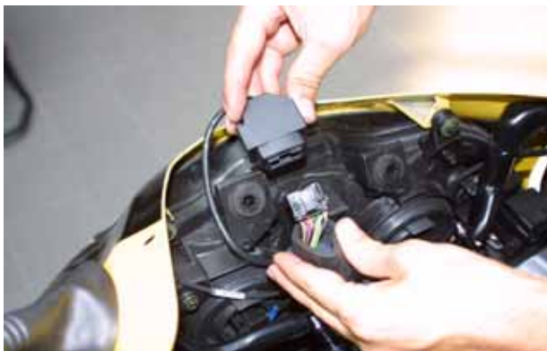
Figura 22: Installazione dei cablaggi particolare del connettore AMP.
