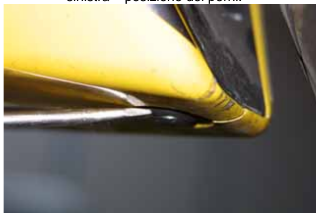
Figura 5: Rimozione del perno di plastica con un cacciavite piatto.
