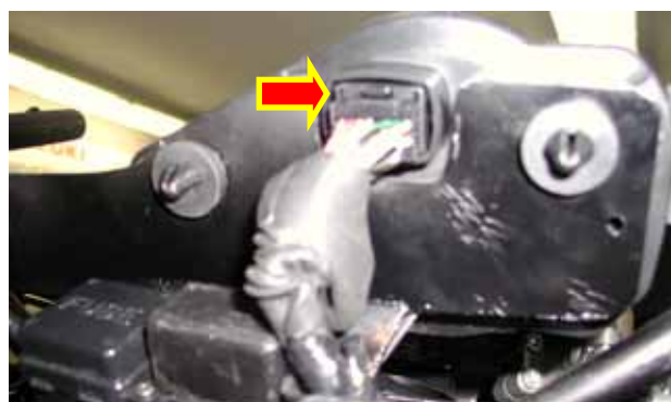
Figura 11: Sganciamento del connettore del cruscotto di bordo.
