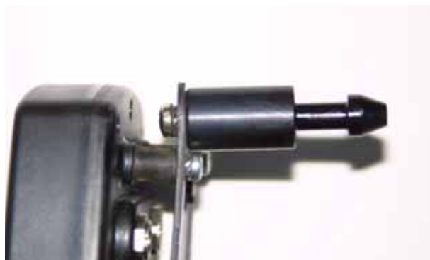
Figura 17: Particolare dell'installazione dei perni di fissaggio.
