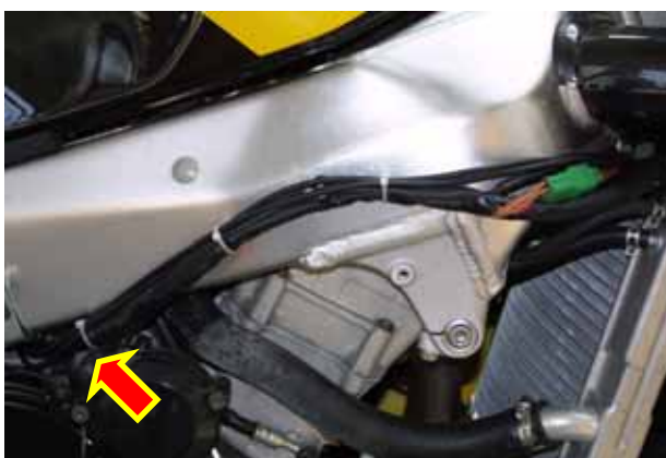
Figura 21: Installazione dei cablaggi – il cablaggio scorre lungo il telaio.
