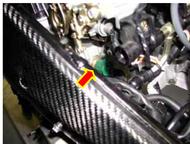
Figura 14: Particolare del connettore di temperatura dell'acqua.
