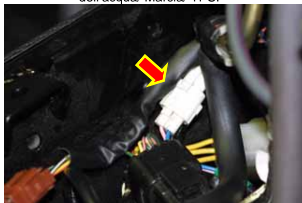
Figura 13: Particolare del connettore di marcia.
