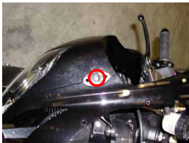
Figura 3: vite centrale esterna.
