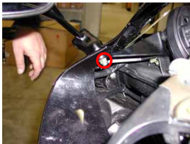
Figura 2: vite interna da rimuovere.
