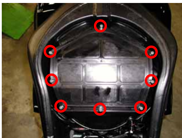
Figura 21: Posizione delle viti dell'Airbox.
