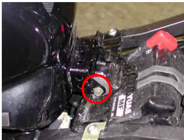
Figura 15: una delle viti che fissano il serbatoio.
