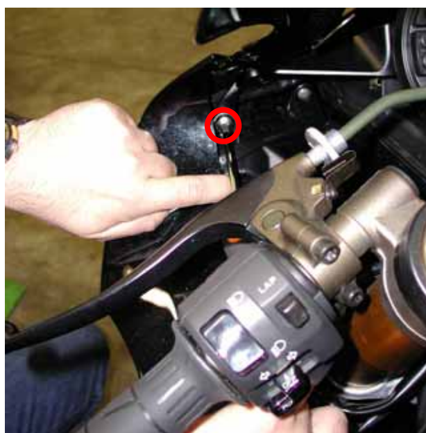
Figura 4: Posizione della vite della carena interna.
