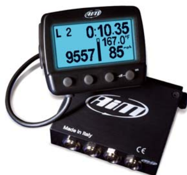
Figura 1: MyChron Light TGLog e la sua junction box
