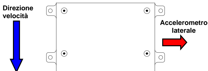
Figura 3 - Installazione – posizione del pannello frontale della Junction box
