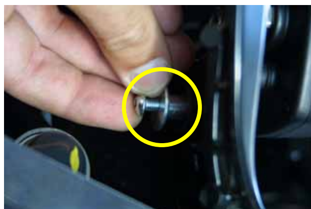
Figura 27: fissare MyChron 3 Plus / Gold alla moto.
