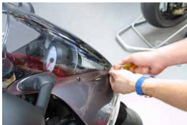
Figura 17: svitare le viti del cupolino
