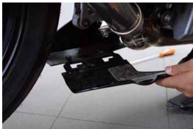
Figura 12: Allargare le giunzioni delle carene laterali
