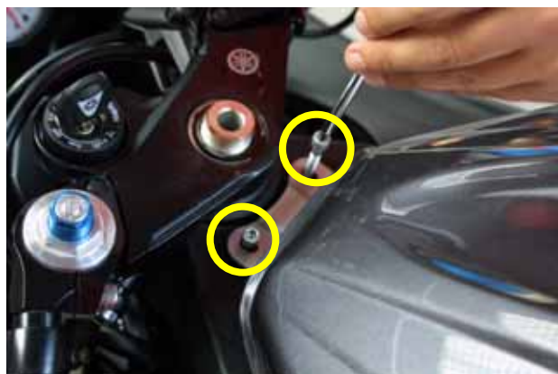
Figura 2: rimozione delle viti del serbatoio.
