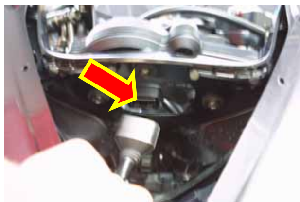
Figura 18: scollegare il connettore del cruscotto di serie
