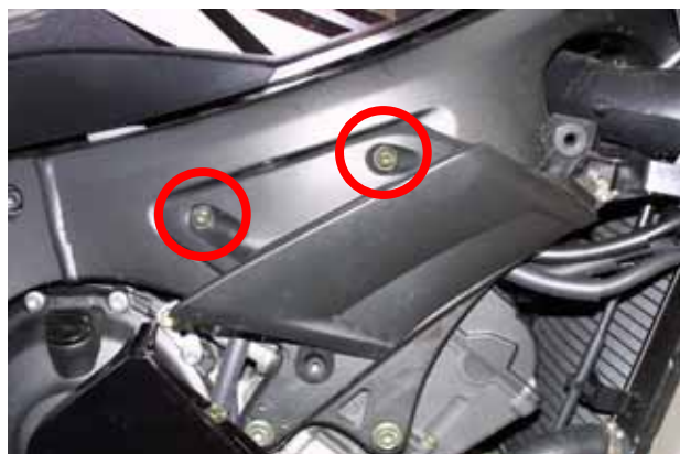
Figura 13: posizione delle viti del telaio protettivo.
