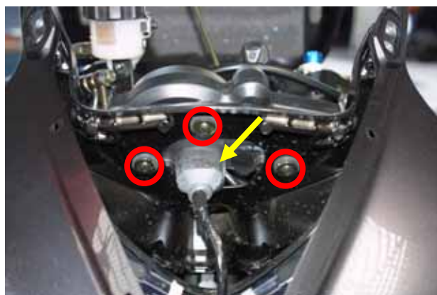
Figura 19: Posizione delle viti del cruscotto di serie.
