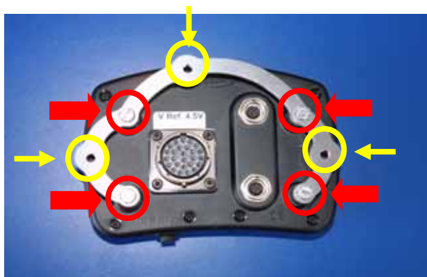
Figura 21: MyChron 3, staffa – vista posteriore
