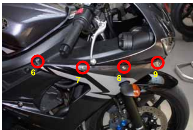
Figura 6: posizione viti da 6 a 9
