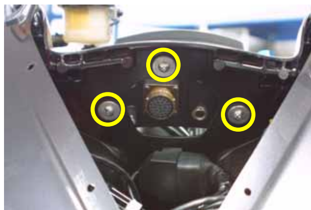
Figura 28: MyChron 3 correttamente installato (vista posteriore)
