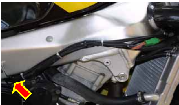
Figura 25: Installazione cablaggi: il cablaggio scorre lungo il telaio.
