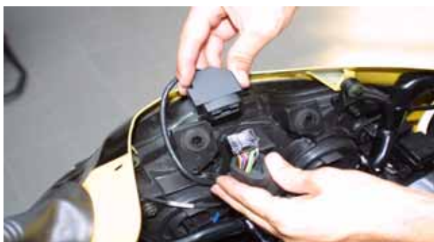
Figura 26: Installazione cablaggi particolare del connettore AMP
