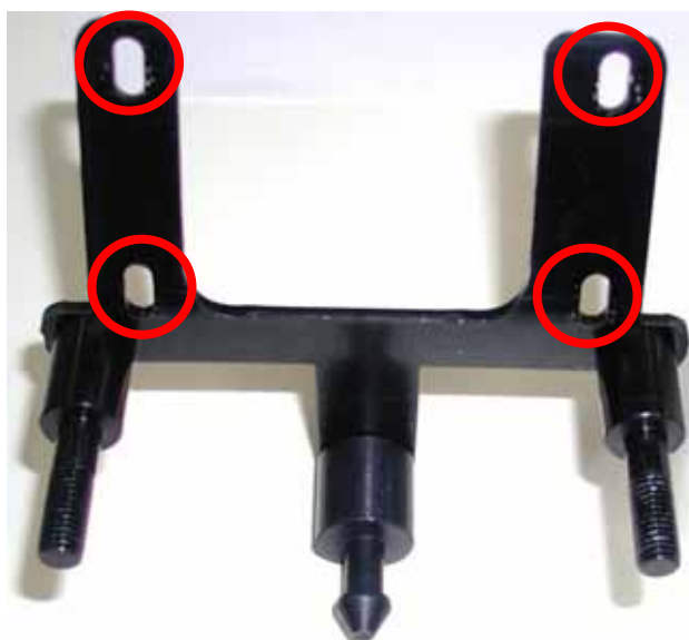
Figura 7: i perni sono fissati alla staffa.
