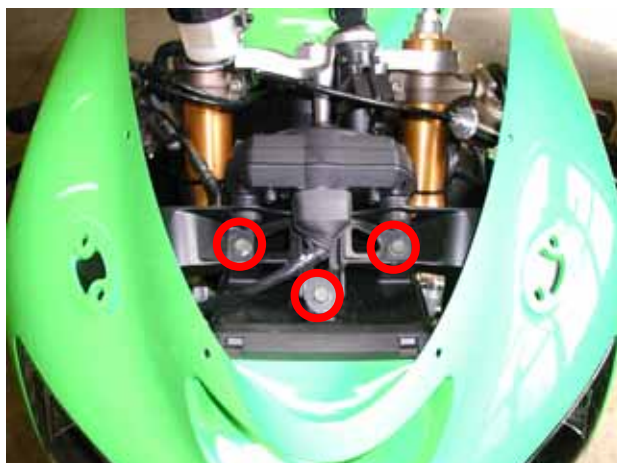
Figura 4: Posizione delle viti del telaio interno.
