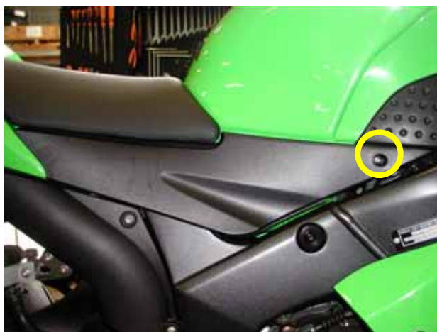
Figura 12: posizione vite del telaietto di plastica.
