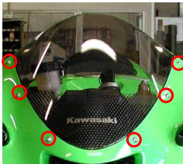
Figura 1: cupolino – posizione delle viti
