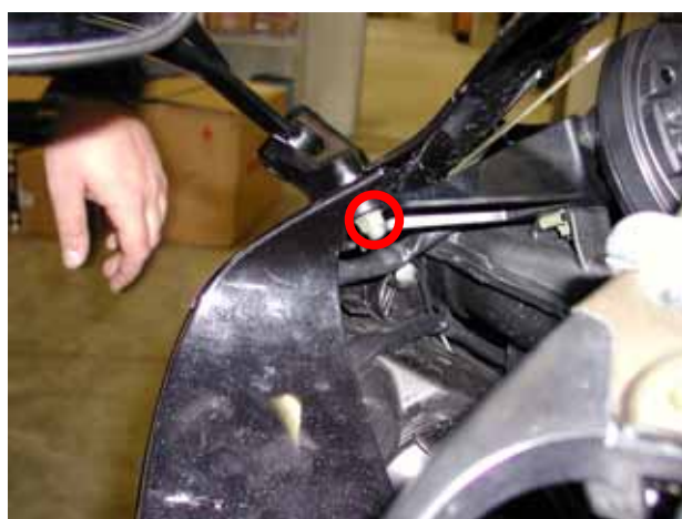
Figura 2: vite interna da rimuovere.
