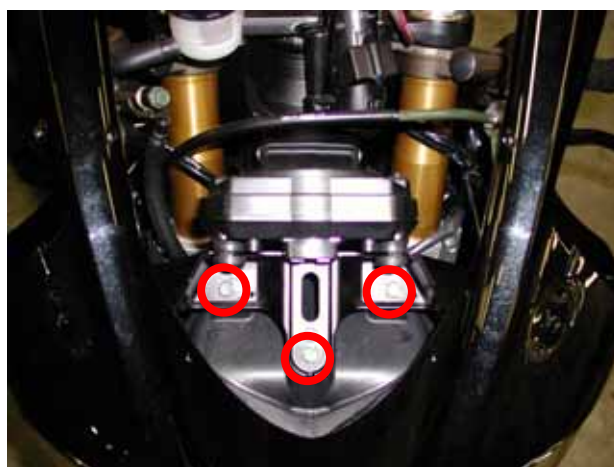
Figura 5: Le viti che fissano il cruscotto di serie ad un telaio interno.
