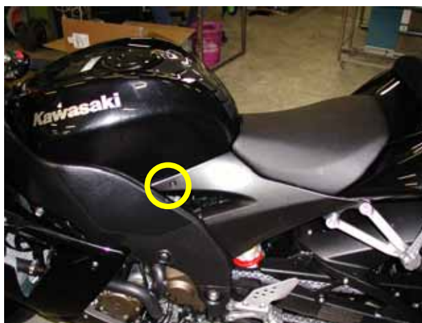
Figura 14: vite che fissa la carena laterale di plastica al telaio della moto
