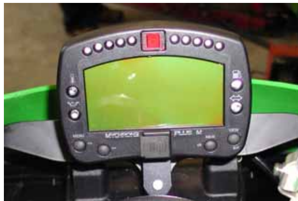
Figura 10: MyChron 3 Plus correttamente installato.
