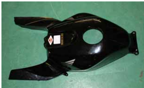
Figura 13: la carena del serbatoio è stata rimossa.
