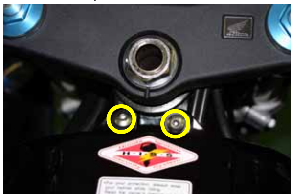
Figura 4: Le due viti frontali del serbatoio.
