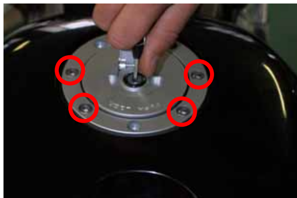
Figura 3: Posizione delle altre quattro viti del coperchio del serbatoio.
