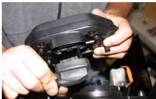
Figura 19: Sganciare il cablaggio di bordo.
