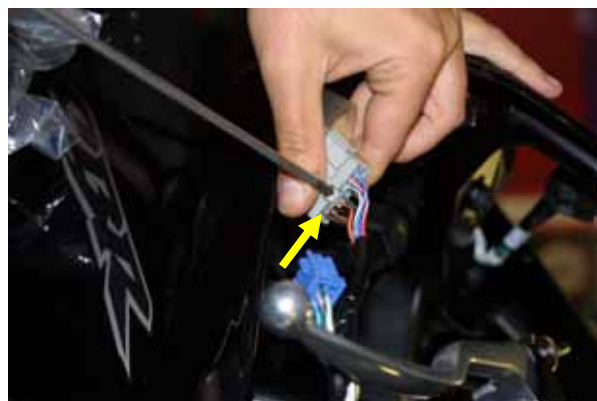
Figura 17: Sganciare i connettori di bordo
