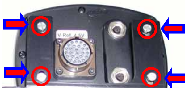
Figura 22: MyChron 3, staffa – vista posteriore
