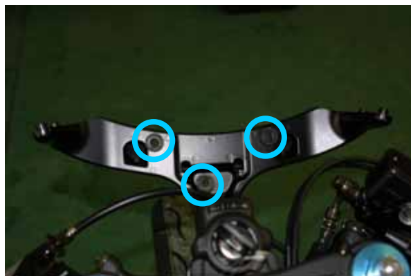
Figura 20: I fori dei perni di fissaggio del cruscotto di serie.
