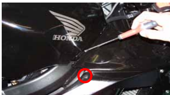
Figura 12: Posizione della spina sotto la carenatura.
