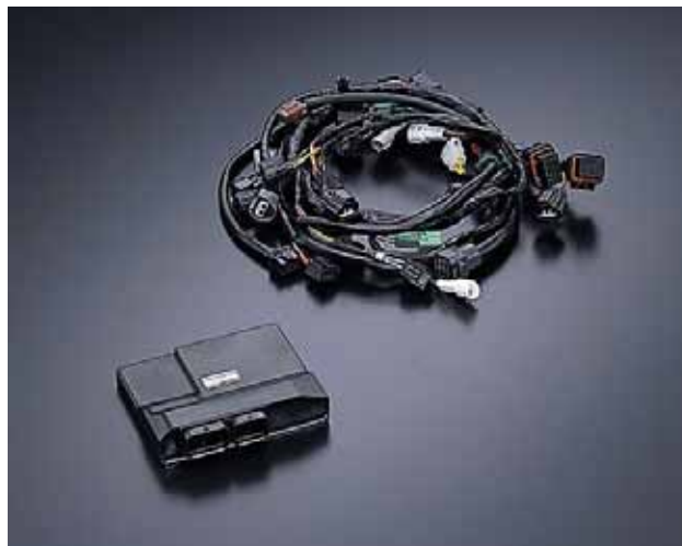
Figura 3: Yoshimura Racing kit: ECU a sinistra e cablaggio a destra
