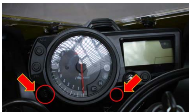
Figura 14: posizione viti frontali cruscotto di serie.
