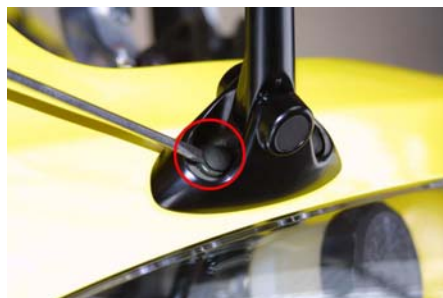
Figura 1: rimozione dei cappucci in plastica.
